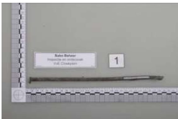
Staal 1, Ø 8 mm, geen corrosie.
