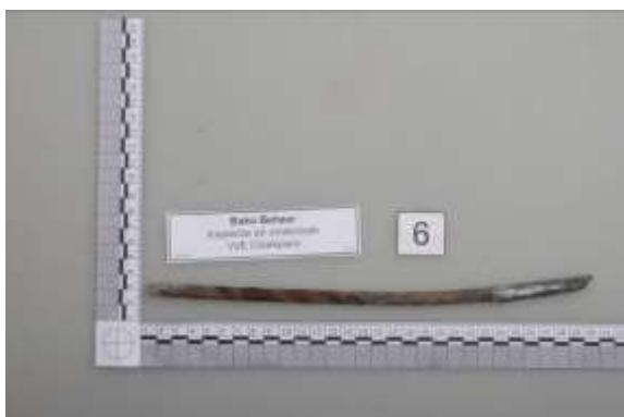
Staal 3, Ø 8 mm, geen corrosie.
