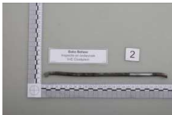
Staal 2, Ø 8 mm, geen corrosie.
